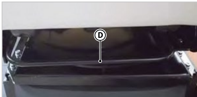
Fig.3.7 - Levier de coulissement du siège
