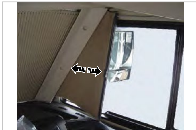
Fig. 6.11 - Stores occultant pliables pour baies latérales
