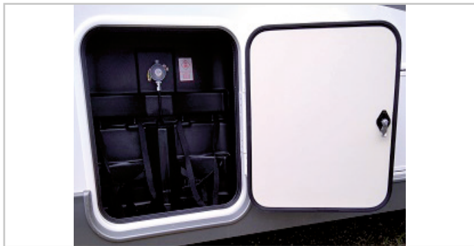
Fig.6.26 - Vano delle bombole del gas
