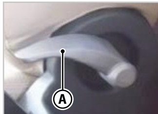
Abb.3.4 - Steuerung für die Rückenlehnenverstellung
