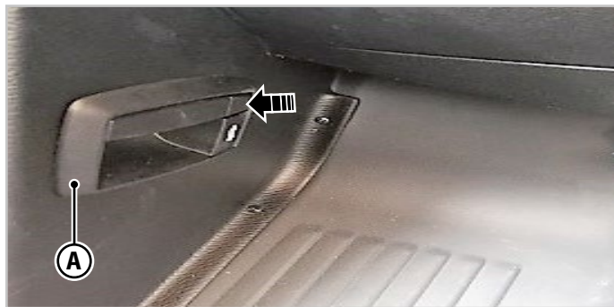
Abb.5.9 - Hebel zum Öffnen der Motorhaube - Typ B
