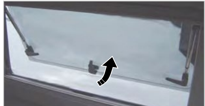
Abb.6.3 - Öffnen der Fenster
