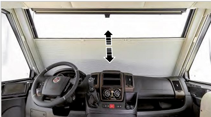
Abb.6.12 - Faltbares Verdunkelungsrollo für die Windschutzscheibe
