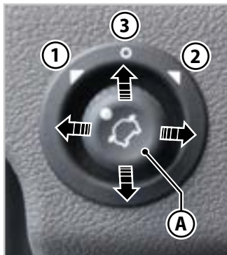
3.1 . ábra - A tükrök beállítása
