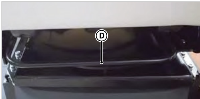
Fig.3.7 - Alavanca de deslizamento do banco
